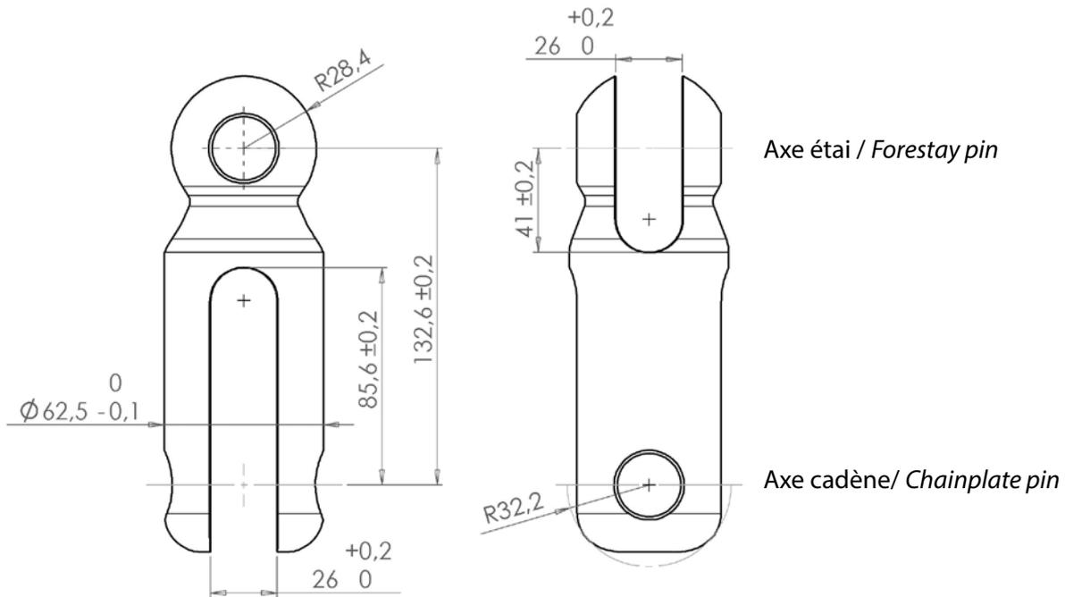
**Dimensions des cardans pour les modèles 480, 520 et 530**
