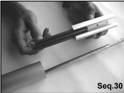
Monter un palier et l'éclisse de raccordement sur le câble et répéter les séquences 24 et 25 (cf page 14).
