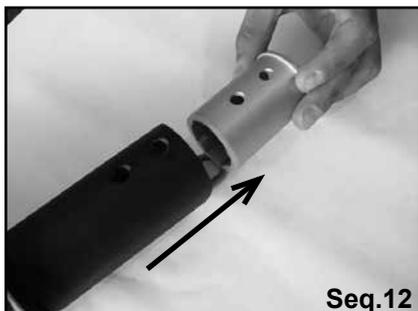
Démonter les vis et retirer le manchon entraîneur.
