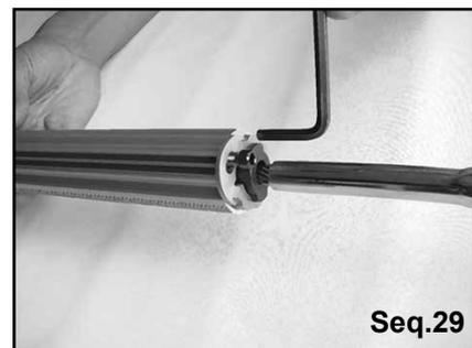
Engager la vis de butée dans la gorge de ralingue et serrer la vis de butée.
