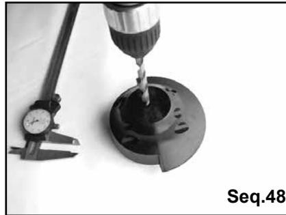
Perçer le Multitop à  $\varnothing -1$  mm.
