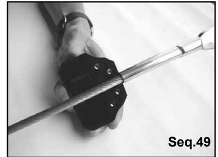
Monter et serrer le Multitop sous le sertissage.
