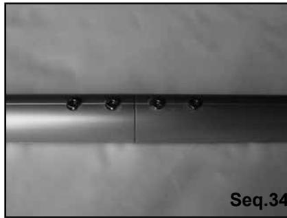
Monter les vis de jonctions et serrer entre 4 et 5 N.m.
