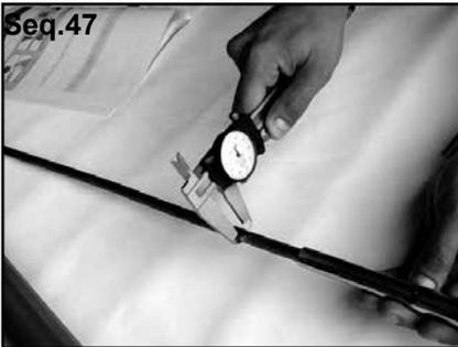
Mesurer précisément le diamètre  $\varnothing$  de l'étau.
